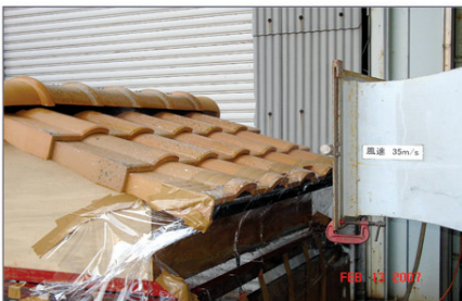
(財)建材試験センター 防水性試験 雨量240mm/h 風速35m/s
